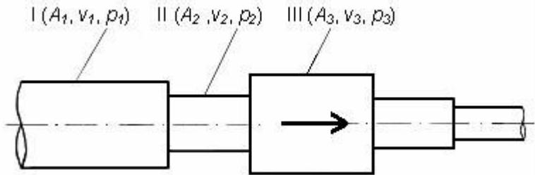
Dati su podaci:  $\rho = 800 \text{ kg/m}^3$ ,  $A_1 = 0,2 \text{ m}^2$ ,  $v_1 = 4 \text{ m/s}$ ,  $A_2 = 0,1 \text{ m}^2$ ,  $p_{2\text{aps}} = 1,2 \text{ bar}$ ,  $v_3 = 4 \text{ m/s}$ . Smjer strujanja je dat na skici. Fluid smatrati idealnim i nestišljivim.
