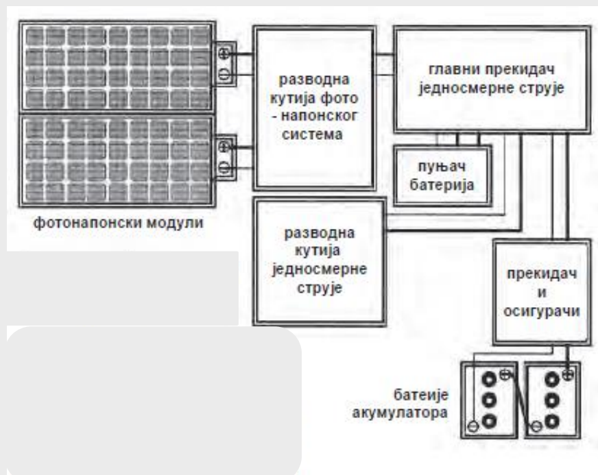
Самостални једносмерни ФН систем са акумулатором
